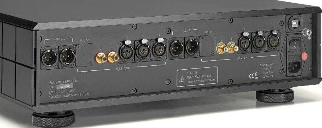
Mustergültige CNC-Verarbeitung: Auf der Rückseite des aus dem Vollen gefrästen Alu-Gehäuses wurden die Anschlüsse nebeneinander gelegt, damit das „Verkabeln“ hochwertiger Signalkabel erleichtert wird. Die abgedeckten Eingänge deuten auf eine optional erhältliche Phonoplatine hin. Wer Phono auf allerhöchstem Niveau hören will, wird vermutlich jedoch eher auf die Igniculus aus gleichem Hause zurückgreifen
